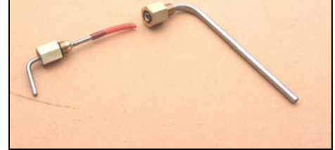
Slide the GTR onto the TOT
